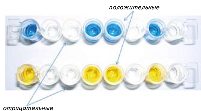
Рис. 2. Визуальная оценка содержания сальмонелл с помощью тест-системы Ridascreen®Salmonella (раствор синего цвета до добавления стоп-раствора, желтого — после)
